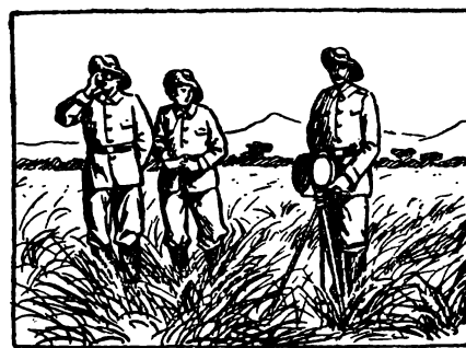
Немецкие войска в юго-западной Африке объясняются при помощи гелиографа, который при благоприятной погоде передает сигналы на 150 км.
